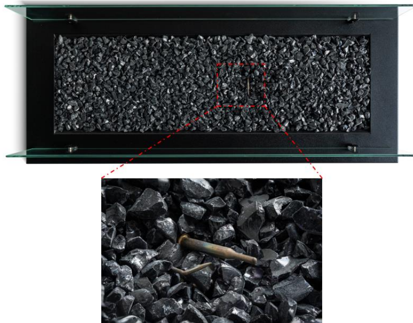
Fig. 2 – Vue de dessus de RIO et détails des éléments d'allumage
